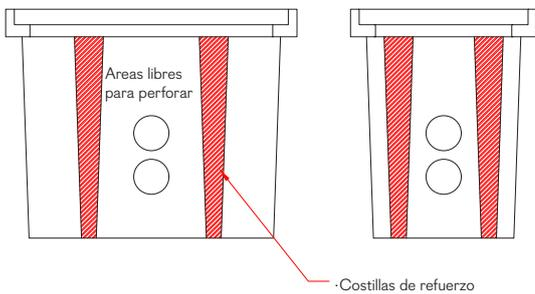
**NOTA:** La herramienta adecuada para hacer las perforaciones es usando sacabocado o esmeril para realizar un corte correcto y definido sin fibra expuesta.
