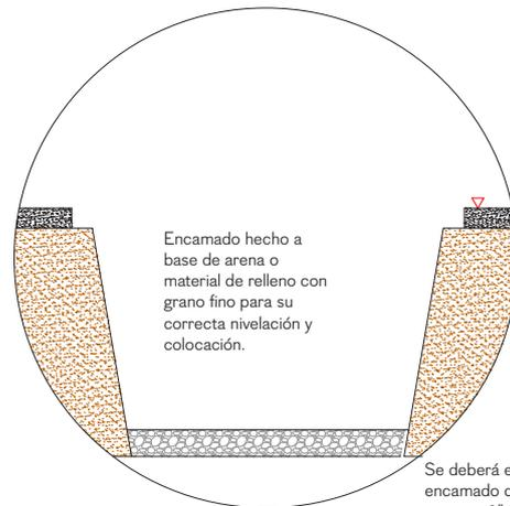
Se deberá emplear un encamado con un grosor no menor a 3" (75mm) considerando NPT. El ancho y largo del encamado deberá ser igual al tamaño del registro 10 cm por lado.
