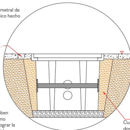
Cuando se requiera de métodos vibratorios para compactar el material de relleno se deberá tener cuidado en no dañar las paredes del registro.
